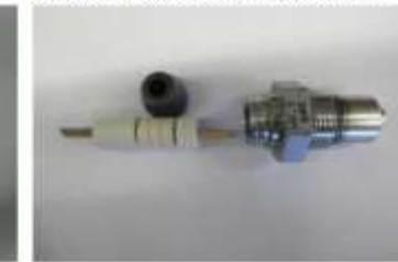
Verbau in Gehäuse mit Schutzrohr
